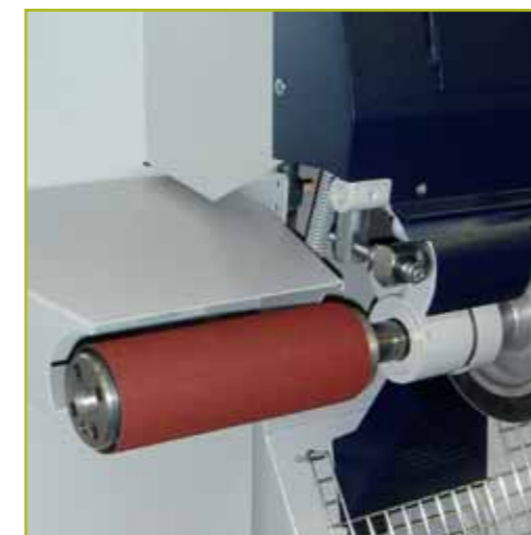
mit Luftscheibe 200x70mm außen with inflated grinding wheel outside met luchtschijf naar buiten avec disque rempli d'air vers l'extérieur
