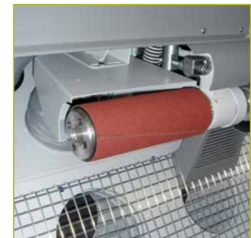
mit Luftscheibe 200x70mm innen with inflated grinding wheel in the middle met luchtschijf in het midden avec disque rempli d'air au milieu
